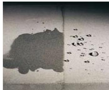
Kamena ploča Serena tretirana sa proizvodom Fila samo na polovici površine. Na desnoj tretiranoj površini uočljive su kapi vode, dok je na drugoj netretiranoj ploča upila vodu.
